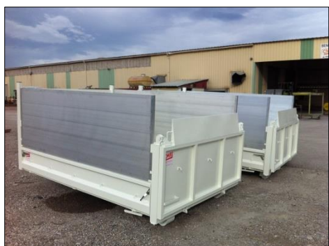
Porte 1 battant servant de rampe
