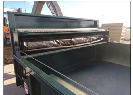
Bâchage Ignifuge par enrouleur avec coffre démontable
