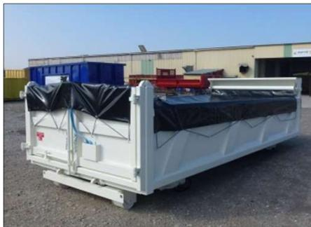
Bâchage Ignifuge type accordéon avec coffre démontable
