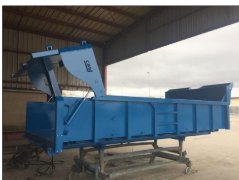
Porte à relevage hydraulique (type guillotine)
